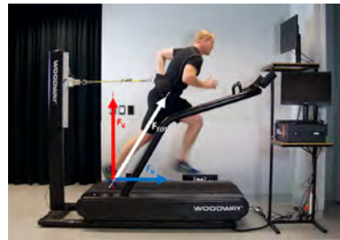
Figure 1 – Sprint d'un joueur de rugby sur tapis roulant non motorisé. Les forces de réaction au sol (force verticale [ F_V en rouge], force horizontale [ F_H en bleu] et force résultante [FTOT en blanc]) sont schématisées.
