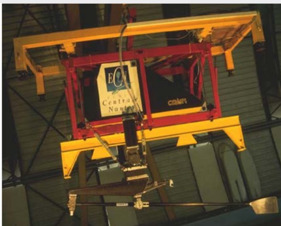
Bassin des carènes et banc de mesure installé sur le chariot du bassin des carènes.
